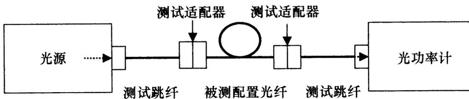
图 7 三跳线链路测试连接方式
