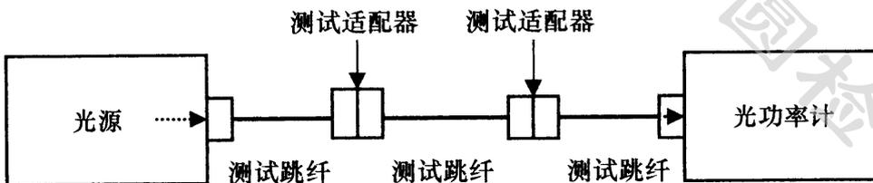
图 6 三跳线测试校准连接方式
