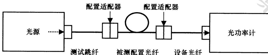
图 3 单跳线信道测试连接方式
