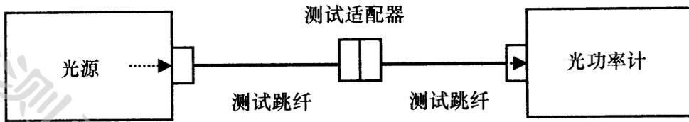
图 4 双跳线测试校准连接方式
