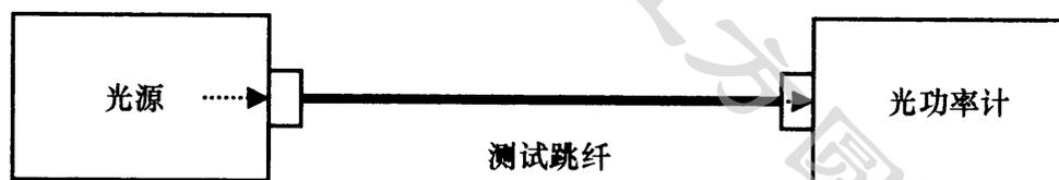
图 2 单跳线测试校准连接方式
