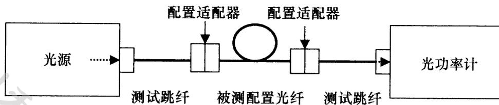
图 8 三跳线信道测试连接方式
