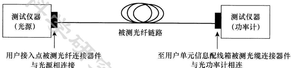
图 C.0.4 光纤链路衰减测试连接方式
