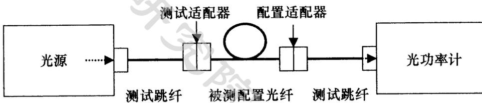
图 5 双跳线信道测试连接方式
