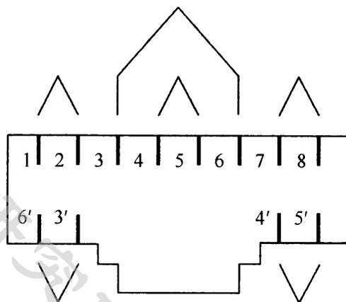
图 7.0.2-2 7 类和 7<sub>A</sub> 类模块插座连接(正视)方式 1
